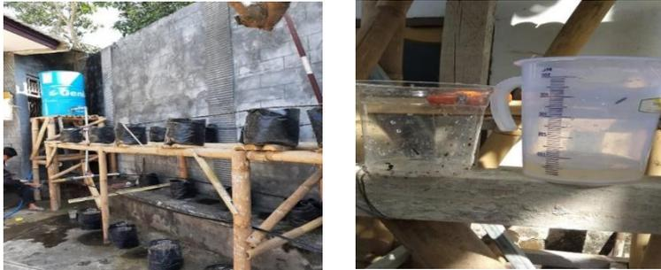
**Gambar 2.** Uji Jaringan irigasi tetes sistem bertingkat
